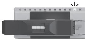
Cuando la tensión de la batería sea baja, el segundo LED de la derecha parpadeará. Cambie las pilas por 2 pilas AA nuevas.
